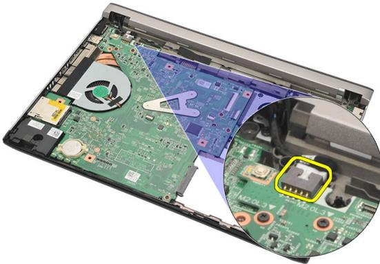
14. 卸下用來固定 DC-In 連接埠的螺絲。
