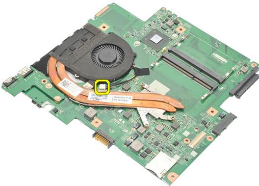
15. 鬆開將散熱器固定至主機板的緊固螺絲。
