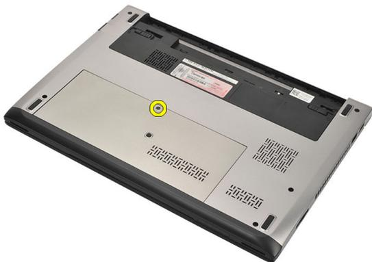
4. 將基座護蓋朝電腦背後推動並卸下。將它從電腦抬起取出。
