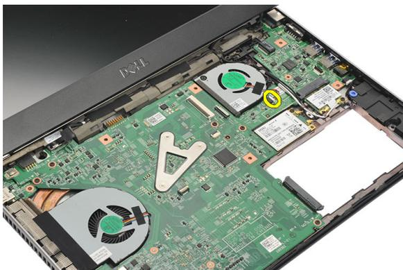
8. 卸下用來將散熱風扇固定至電腦的螺絲。
