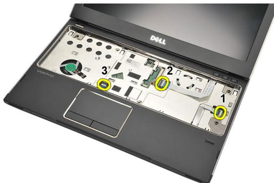
9. 請使用塑膠劃線器輕輕撬起手掌墊兩側，並將它從電腦卸下。
