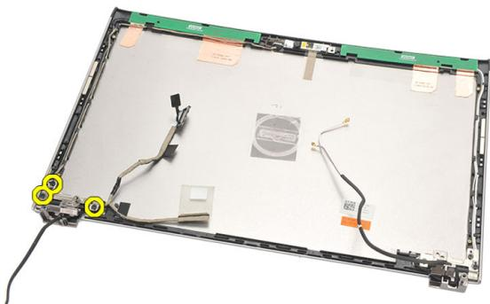
13. 將左側顯示器鉸接從顯示器拆下。
