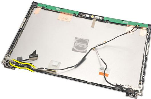
11. 將低電壓差動訊號 (LVDS) 纜線從左側顯示器鉸接拆下。
