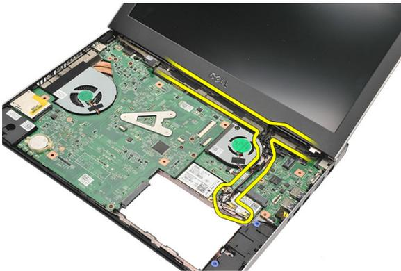
9. 將顯示器纜線從電腦拔下，然後將它從固定導軌鬆開。
