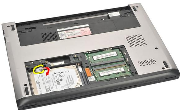
7. 卸下用來將硬碟機托架固定至硬碟機的螺絲。將硬碟機從硬碟機托架取下。
